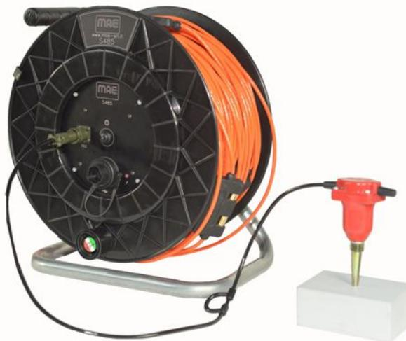
Sismografo per sismica attiva e passiva ad architettura distribuita con numero di canali configurabili liberamente da 1 a 24. Il sistema S485 si compone di una serie di acquisitori/digitalizzatori miniaturizzati, dotati di prese standard con attacco Mueller per geofoni, distribuiti lungo il cavo.
